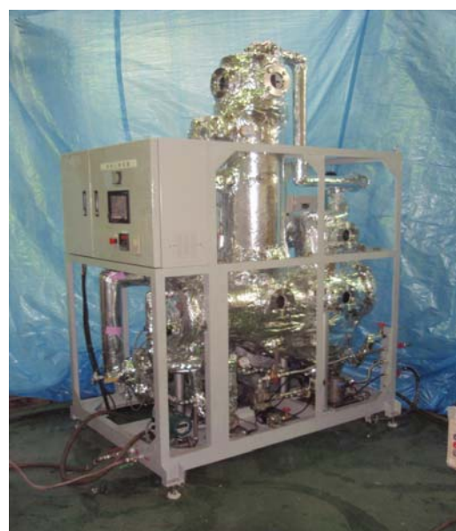
ヒートポンプ式テスト機
