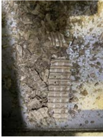
設置前 酸洗浄後一ヶ月でスケールが大量付着
