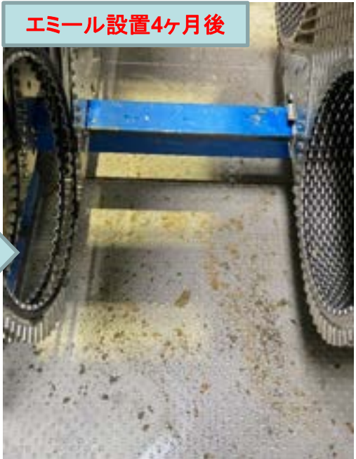
エミール設置後 開放時、スケール付着はほとんど確認されず！
